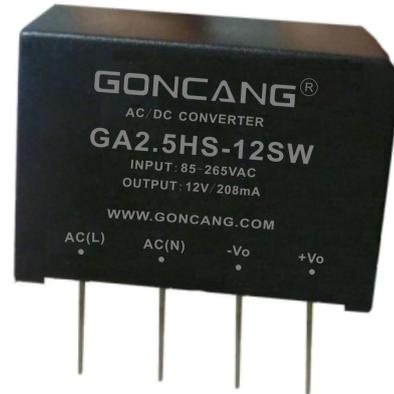
GA\_HS-系列 AC-DC 模块电源具有全球输入电压范围、交直流两用、低功耗、高效率、高可靠性、安全隔离等优点。产品安全可靠，抗浪涌性能优越，EMC 及安全规格满足 IEC/EN6100-4、CISPR22/EN55022、UL60950 和 EN60950 等标准。该系列产品广泛用于工业中，当使用于电磁兼容比较恶劣的环境时必须参考应用电路。
